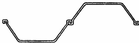
U-Profile: PU & AU Width: 600 - 750 mm W_x : 600 - 3200 cm 3 / m
